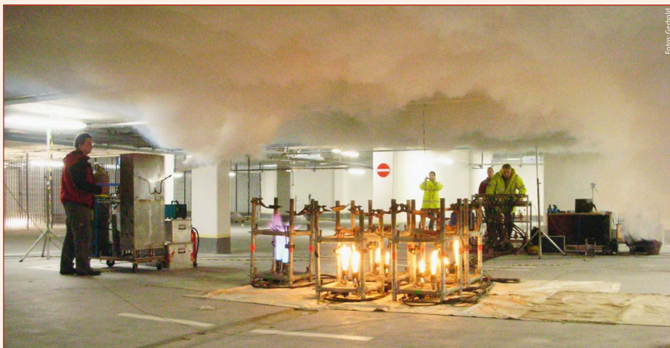
Abb. 1: Physikalischer Modellversuch in einer Tiefgarage
